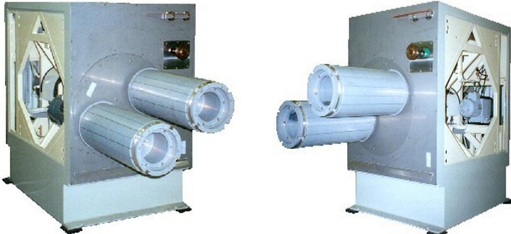
Kokonová navíječka ND300.2D je určena pro automatické navíjení skelného vlákna taženého ze sklářské pece a navíjeného na cívky navíječky. Tvary a velikosti návinů, stejně jako tloušťka vlákna, závisí na rychlosti tažení a jsou přesně definovány v tzv. navijecím předpisu.
