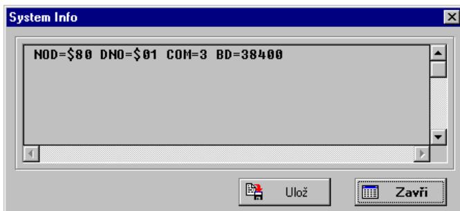
Je-li natavena systémová přístupová úroveň, lze nastavení zeditovat a tlačítkem **Ulož** změny uložit zpět do INI-souboru. Po změně parametrů je třeba program **RESTARTOVAT!** Chybné nastavení COM může způsobit "zatuhnutí" programu nebo ovladače sériového kanálu.
