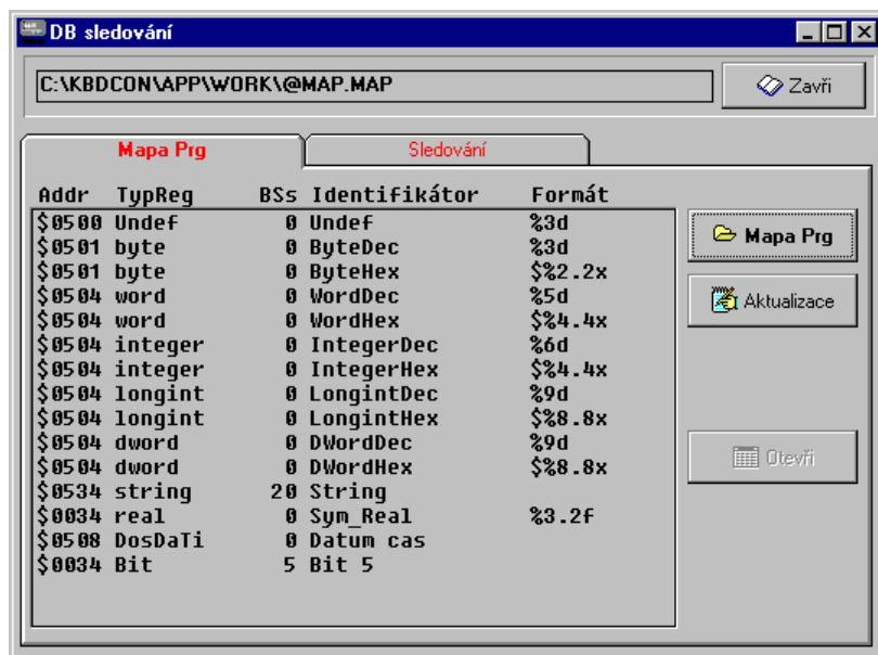
**DB sledování** obsahuje informace mapující jednotlivé proměnné programu v **Kit-Basicu** na adresy registrové datové struktury systému **Kit-Builder** a doplňující informace nezbytné k zobrazení proměnných.
