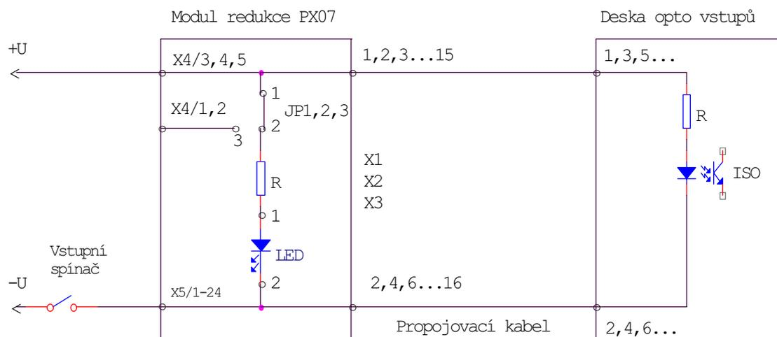
Je-li určitá osmice signálů redukce použita na připojení výstupů, musí být indikační LED v objímkách orientovány tak, aby byly anody připojeny na signály svorkovnice X5 a katody na pracovní odpory (špičky 1 objímek). Příslušným přepínačem musí být pracovní odpory připojeny na pomocnou napájecí svorku X4/1 nebo X4/2, kterou je nutno připojit na záporný pól zdroje.
