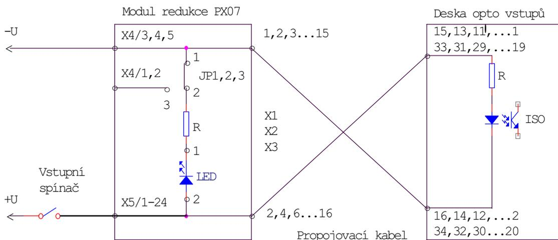
Je-li určitá osmice signálů redukce použita na připojení výstupů, musí být indikační LED v objímkách orientovány tak, aby byly katody připojeny na signály svorkovnice X5 (špičky 2 objímek) a anody na pracovní odpory. Příslušným přepínačem musí být pracovní odpory připojeny na pomocnou napájecí svorku X4/1 nebo X4/2, kterou je nutno připojit na kladný pól zdroje.
